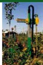
MONTAGEM AOS 3 PONTOS DO TRATOR PARA ESTACAS DE 1,20 ATÉ 4,60 M.
