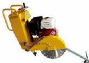
MÁQUINAS CORTADORAS DE JUNTAS PARA OS MAIS DIVERSOS TIPOS DE PISOS EM BETÃO
