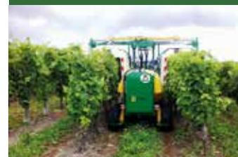
PULVERIZADOR COM PAINÉIS RECUPERADORES AVANÇADOS
